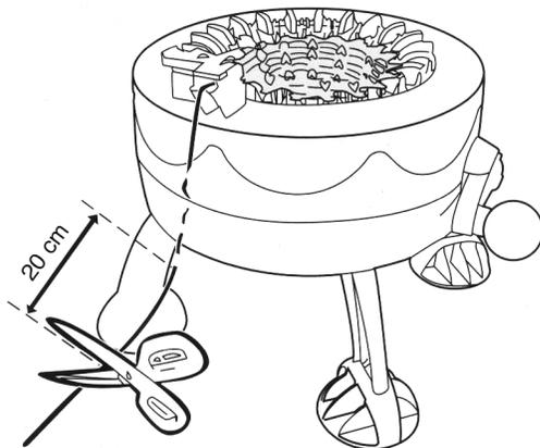
Corta el estambre y junta un nuevo estambre como se muestra en la figura. Y luego continúa girando la manivela para seguir tejiendo gira suavemente la manivela cuidando que el nudo no interfiera con el movimiento de las agujas.
